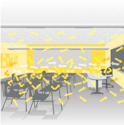
Kuva 2. Äänikenttä vakiotilassa äänilähteen tuottaessa jatkuvasti ääntä huoneessa, jossa on ääntävaimentava sisäkatto ja ääntä hajottavia esineitä.
