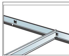
Korridorprofil, positioniert durch den modularen Wandwinkel
