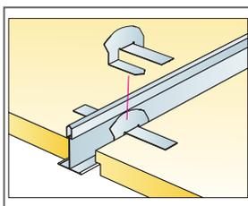
Connect Sicherungsclip E (patentiert)
