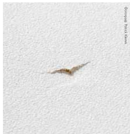
Тестирование на ударопрочность*: стандартные панели Akutex FT
