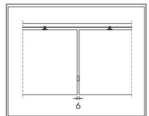
Con el accesorio Connect Pieza de separación p/Baffles se define un espacio de 6 mm entre baffles
