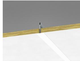
Coupe sur système Advantage A sur ossature Connect T24
