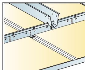
Montage mit Hauptschiene PL und Distanzprofil
