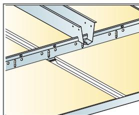
Montage mit Hauptschiene PL und Distanzprofil
