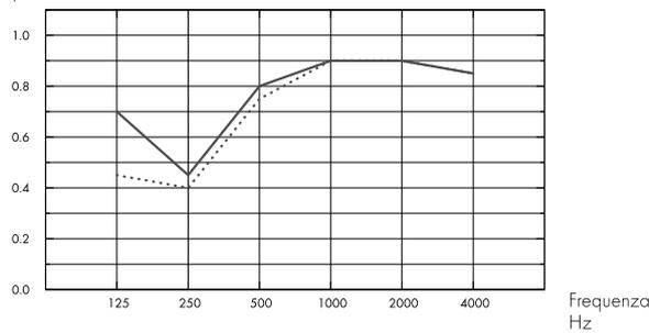
.... Performance Baffle orientati per file, con ~1,4 baffles/m<sup>2</sup> di area del soffitto, 600 mm o.d.s.
