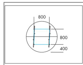
Suspension avec les câbles de suspension ajustables Connect sur profil porteur Connect T24
