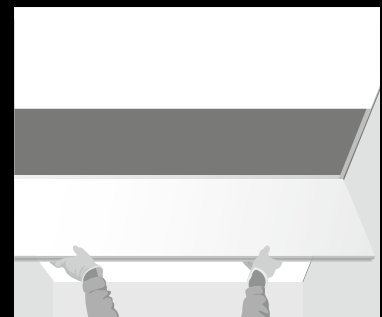
Tijdens installatie wordt het plafondpaneel tegen de veer in het profiel gedrukt, waardoor het in de groef vastklikt
