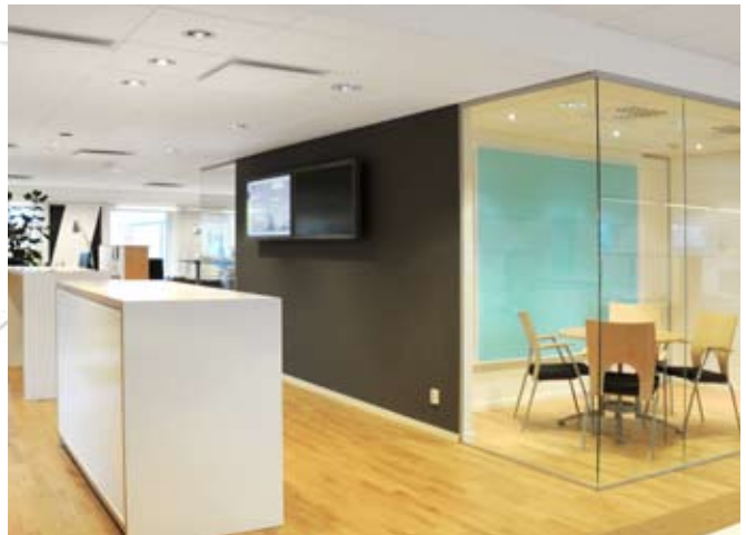
In een ruimte met rechte, harde wanden, voorkomen wandabsorbers elke flutterecho.
